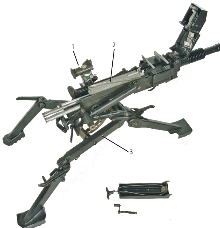
1 – zaměřovač, 2 – tělo granátometu, 3 – podstavec
